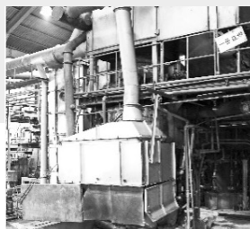
立型還元炉では、還元剤である コークスの材質を変えることで 生産性が向上した
